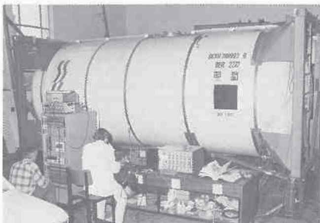
Meting van vermoedheid en vervormings op 'n vloeistof-vraghouer deur middel van moderne rekstrokietoerusting (Mega-niese Ingenieurswese)
