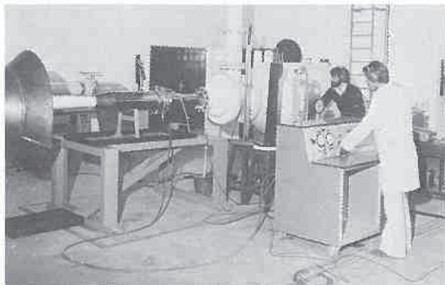
'n Stustraalenjin word getoets in die laboratorium vir vliegtuigandrywing (Meganiese Ingenieurswese)
