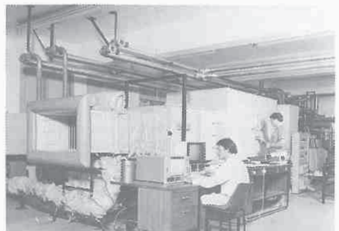
Warmteuitruilertoetse met gerekenariseerde dataversameling vind plaas in die toets-tonnel (Meganiese Ingenieurswese)
